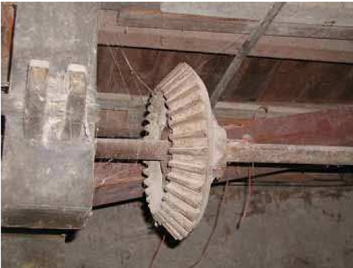
Transmissions par engrenages dans un moulin
