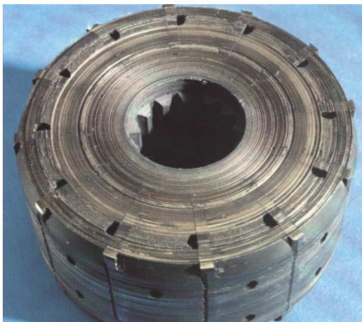
Exemple de rotor de pompe détérioré par la pollution de l'huile
