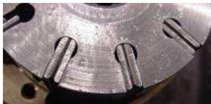
Détails palettes doubles: étanchéité réalisée par poussée hydraulique
